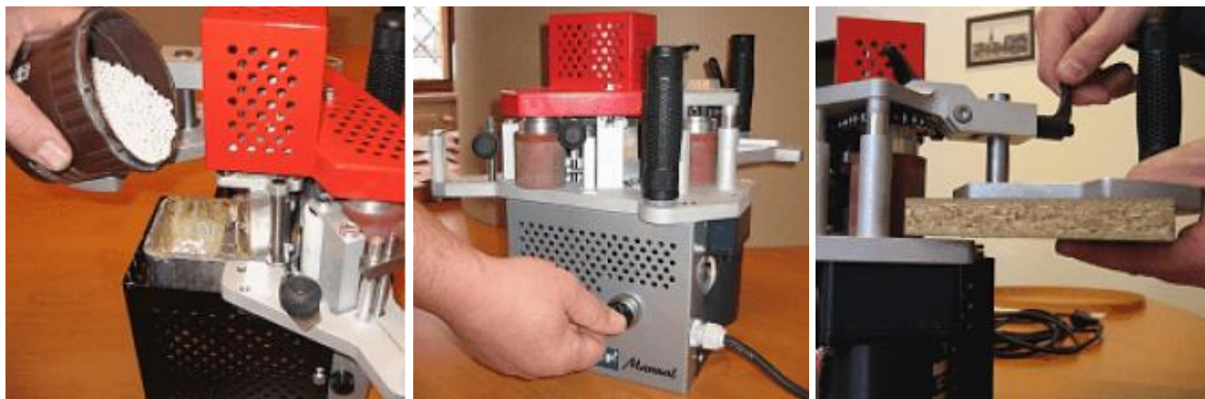
Plnění strojku lepidlem, zapínání, nastavování výšky olepovaného materiálu materiálu.
